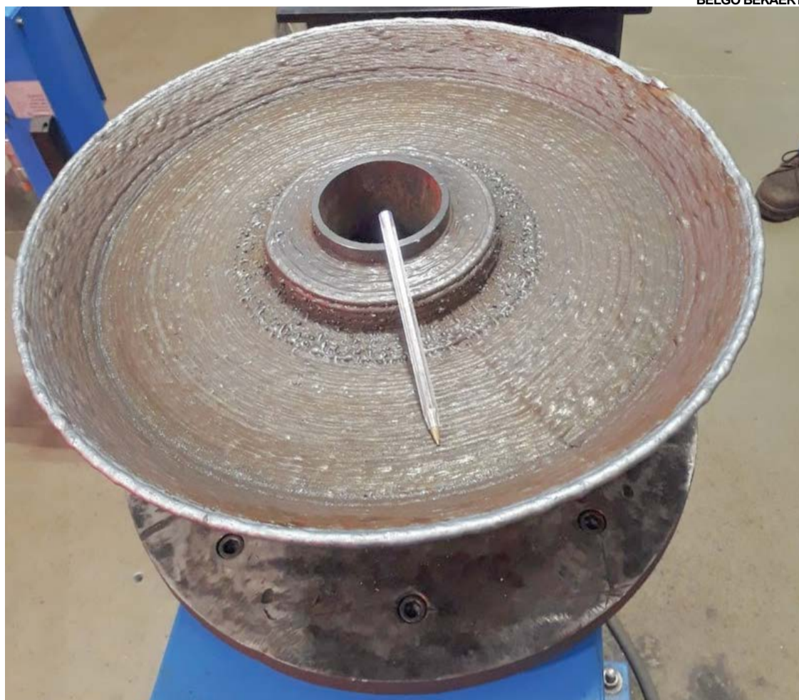
ROLDANA feita à partir de impressão 3D será testada na fábrica da Belgo em Contagem (MG)
